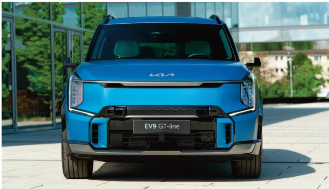
las ruedas delanteras para conseguir tracción total eléctrica y mucha más potencia. Tiene doble motor eléctrico que produce 379 caballos de fuerza y 443 libras pie de torque.
