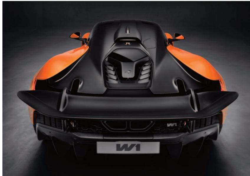
"El escape cuenta con colectores tubulares diseñados para maximizar la participación del conductor y el rendimiento, con conductos largos e iguales, ajustados para aumentar el sonido a medida que el motor se acerca a su límite electrónico de 9,200 rpm", dijo McLaren.
