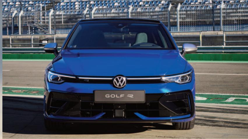
extiende mediante un alerón que ayuda a optimizar la aerodinámica, junto con elementos de flujo lateral en el poste D y cortinas de aire en el parachoques delantero.
